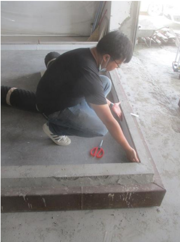
照片 5 試驗件組裝過程(黏貼緩衝邊條)
